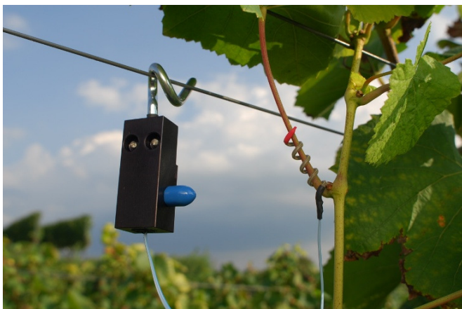
Model eines Messsystems für die Ableitung elektrischer Signale von einer Weinrebe.
