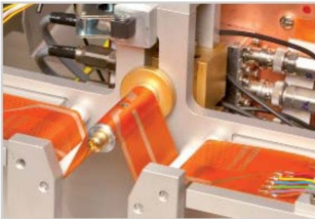
Bild 1: Messung von Transistoren mit Biegevorrichtung
